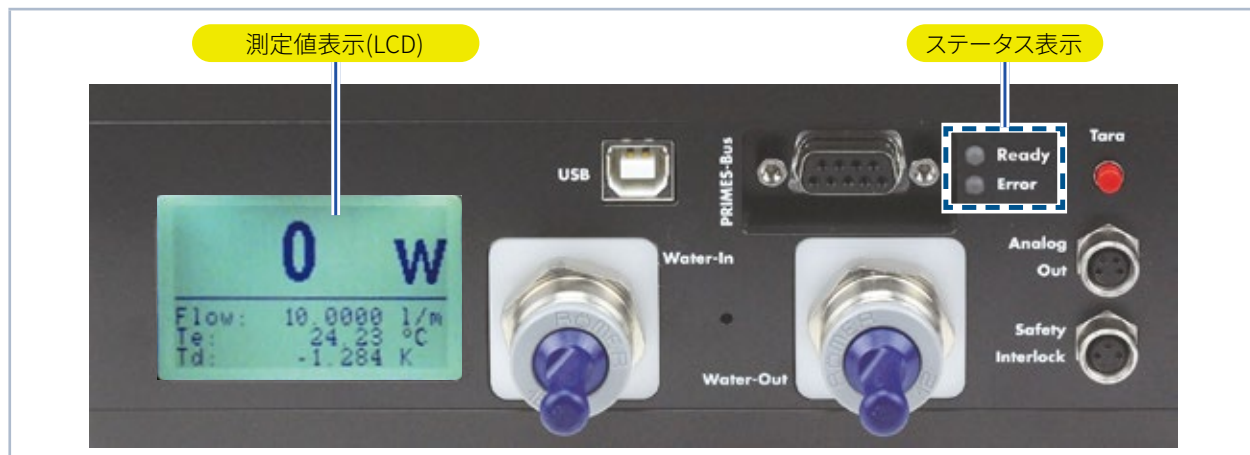
図 10.1: コンパクトパワーモニタCPMの表示画面
